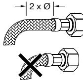
**I** Prima dell'installazione controllare la presenza e l'integrità delle gaffature da ambo i lati dei flessibili.
