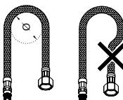
**I** Non installare il flessibile in torsione o in tensione.
