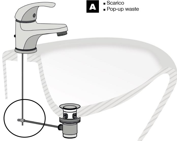
**I** Collegare l'astina di apertura/chiusura dello scarico, se presente, alla piletta per mezzo del morsetto a snodo.
