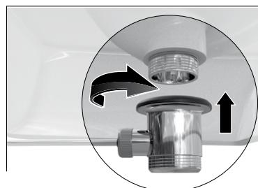
**I** Montaggio dello scarico automatico.
